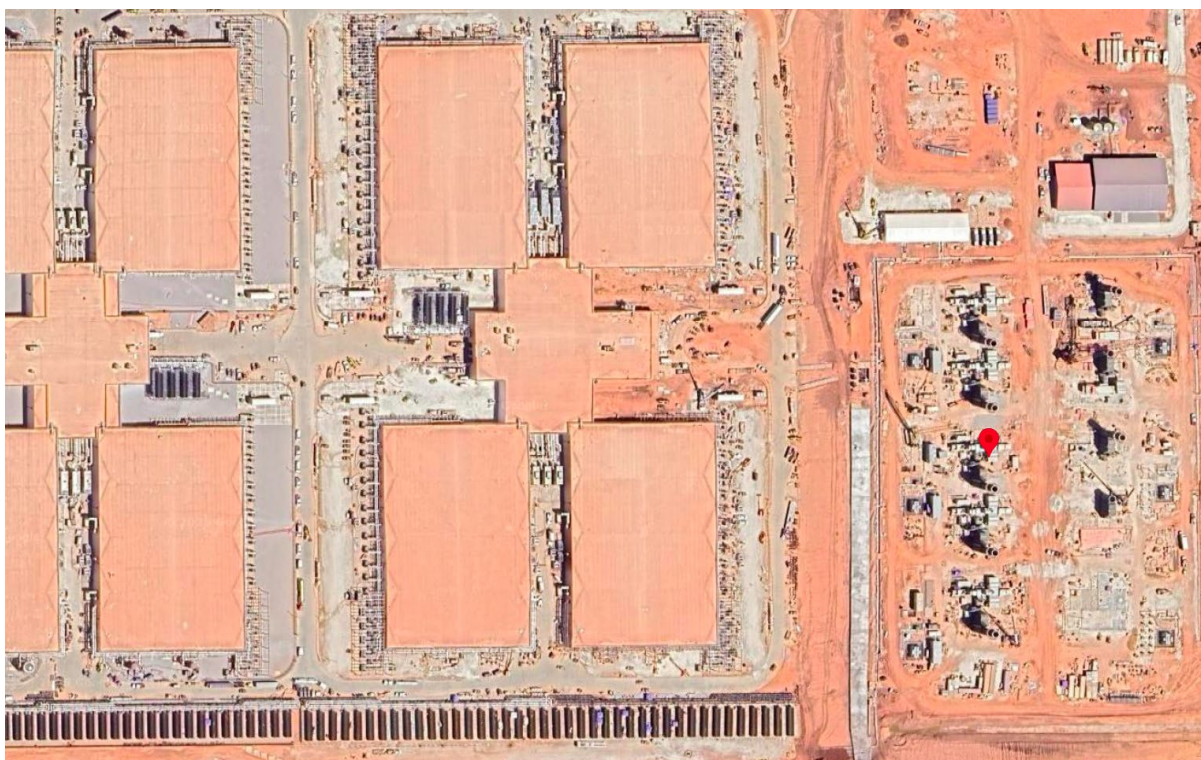
Image agrandie d'une partie des centres de données du site Stargate I d'Open AI (4,5GW à terme), à Abilene, sous le curseur rouge, les génératrices au gaz, donc les cheminées sont apparentes. 119
