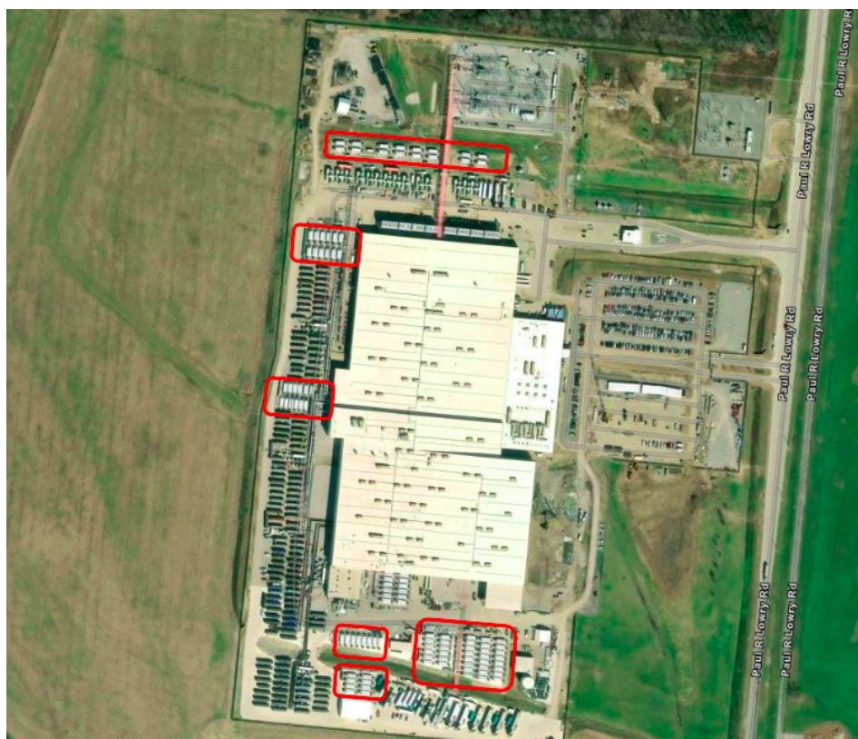
Centre de données Colossus I d'xAI, les Tesla Megapack sont encadrées en rouge
